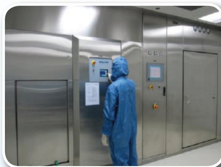
เครื่องนิ่งฆ่าเชื้อด้วยไอน้ำ ยี่ห้อ Belimed จากประเทศสวิตเซอร์แลนด์และเครื่องอบฆ่าเชื้อขวดและอุปกรณ์ผลิตด้วยความร้อนแห้ง จากประเทศเดนมาร์ก
