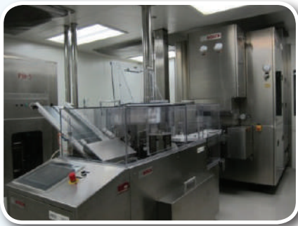
เครื่องล้างขวดอัตโนมัติและเครื่องฆ่าเชื้อแบบอุโมงค์ (Automatic vial washer and Sterilizing tunnel)
