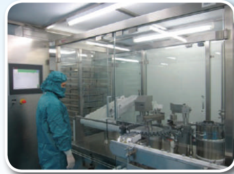
เครื่องล้างขวดและแอมพูลอัตโนมัติ (ภาพซ้าย) และเครื่องบรรจุขวดและแอมพูลอัตโนมัติ (ภาพขวา) ยี่ห้อ Bosch จากประเทศเยอรมนี
