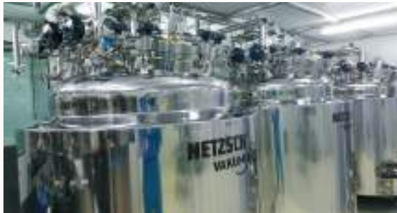
ถังผสมขนาด 600 ลิตรและระบบท่อสเตนเลส จำนวน 3 ถัง และระบบกรองชนิด Tangential Flow Filtration จากประเทศเยอรมนี สำหรับใช้ในกระบวนการทำเซรุ่มให้บริสุทธิ์และเข้มข้น
