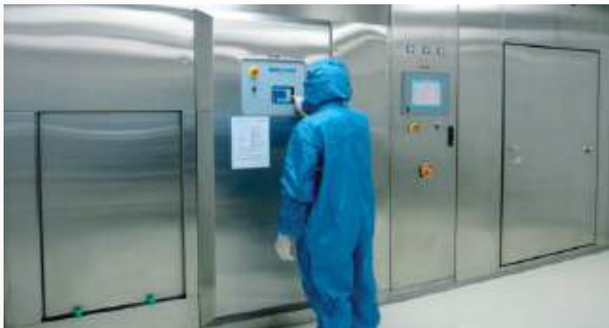
งานอบฆ่าเชื้ออุปกรณ์และน้ำยาด้วยเครื่องนึ่งฆ่าเชื้อด้วยไอน้ำจากประเทศสวีเดนแลนด์ และเครื่องอบฆ่าเชื้อขวดและอุปกรณ์ผลิตด้วยความร้อนแห้งจากประเทศเดนมาร์ก
