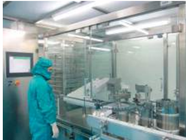
งานบรรจุ งาน Freeze-drying และงานครอบฝาชะรุ่ม ด้วยเครื่องบรรจุขวดและแอมพูลอัตโนมัติ เครื่องเยือกแข็งและทำแห้งและเครื่องครอบฝาชะรุ่มอัตโนมัติ
