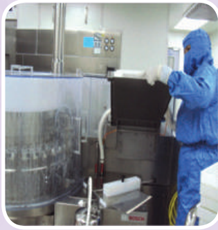
เครื่องล้างขวดอัตโนมัติ (Automatic washer)
