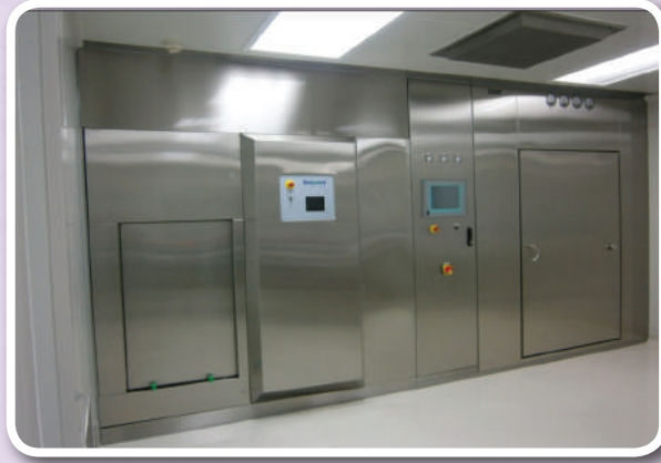
เครื่องนึ่งฆ่าเชื้อด้วยไอน้ำจากประเทศสวีเดน (ซ้าย) และเครื่องอบฆ่าเชื้อด้วยความร้อนแห้งจากประเทศเดนมาร์ก (ขวา)
