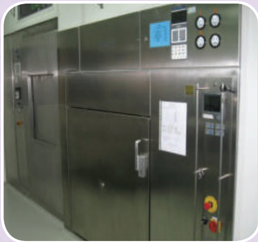
เครื่องล้างขวดอัตโนมัติ (Automatic washer)
