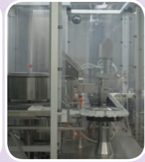
เครื่องบรรจุและเครื่องรีดฝา (Filling & Capping machine)
