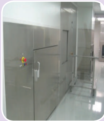
เครื่องอบฆ่าเชื้อแบบอุโมงค์ (Sterilizing Tunnel)
